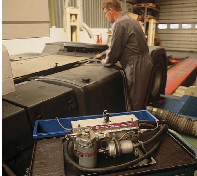
Bij het belast testen kan ook het brandstofverbruik worden gemeten. Het ‘vertalen’ naar een realistisch verbruik op de openbare weg blijkt echter niet eenvoudig
