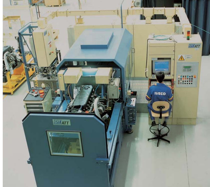
In de ultramoderne fabriek in Bourbon-Lancy worden de Cursor-motoren geproduceerd en proefgedraaid. Eén technicus bouwt zelf de motor op, test alle componenten en draagt de eindverantwoording.
