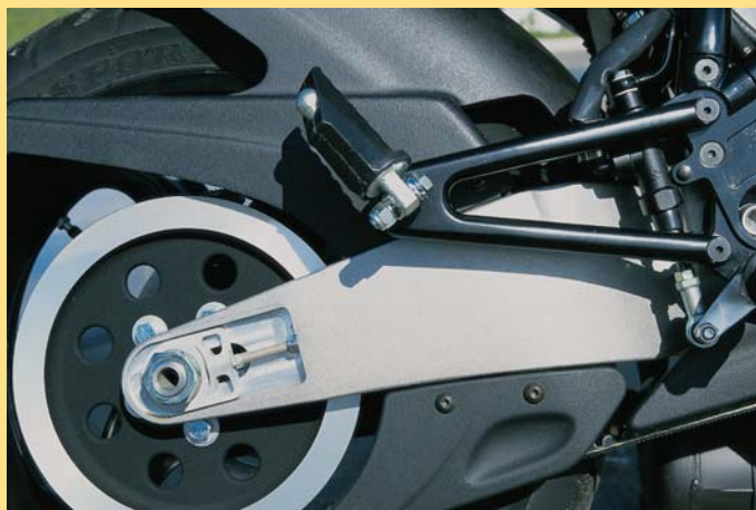
De achtervork bestaat uit een aluminium gietstuk dat buig- en torsiestijf is.
