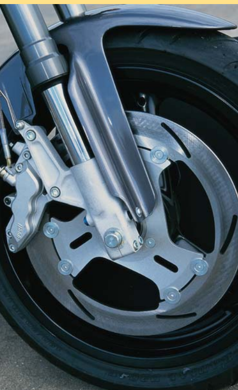
Buell koos voor één schijfrem van ø340 mm voor met een zeszuiger remklauw. Daarmee wordt 2 tot 3 kg op het onafgeveerde gewicht bespaard.
