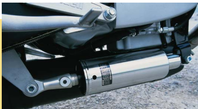
Het veerelement ligt horizontaal onder het carter en is via een hefboom met trekstang verbonden met de achtervork.
