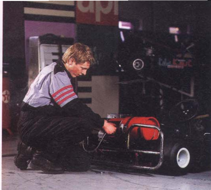
De propaan fles weegt leeg 6 kg en vol 9,5 kg. Het wisselen van de gasfles gaat, dankzij uitgekiende snelsluitingen, binnen enkele seconden.
