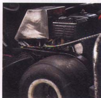
De gastoevoer loopt langs de hete uitlaat, waardoor een goede verdamping is gewaarborgd.
