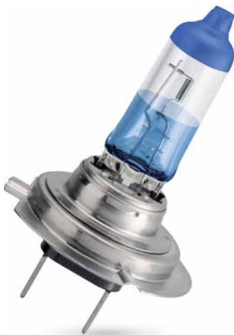
Philips ColorVision is een nieuw product. Het geeft de koplampreflector een kleur. Het licht naar voren blijft wit. In de base zijn de lussen te zien die Philips maakt nadat de gloeidraad op de juist plek zit.
