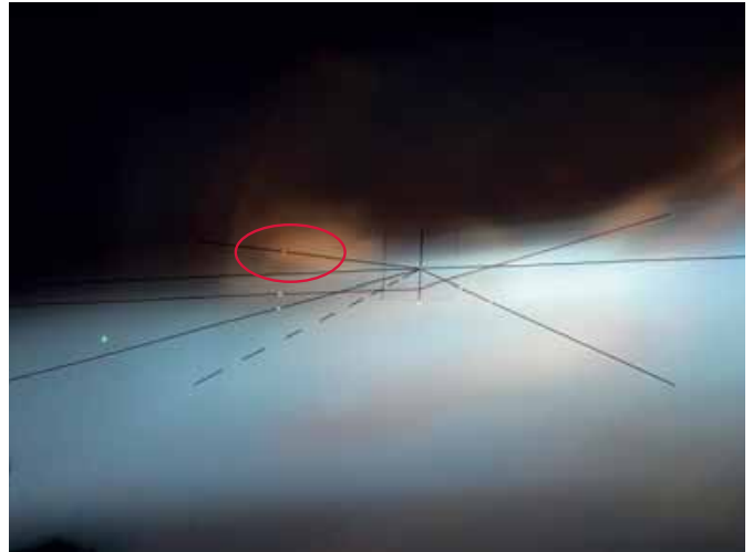
Het lichtbeeld van goedkope lampen klopt vaak niet. Het gevolg is dat tegenliggers verblind worden. De rode led geeft de ooghoogte van een tegenligger aan. Die wordt in dit geval dus volledig verblind.
