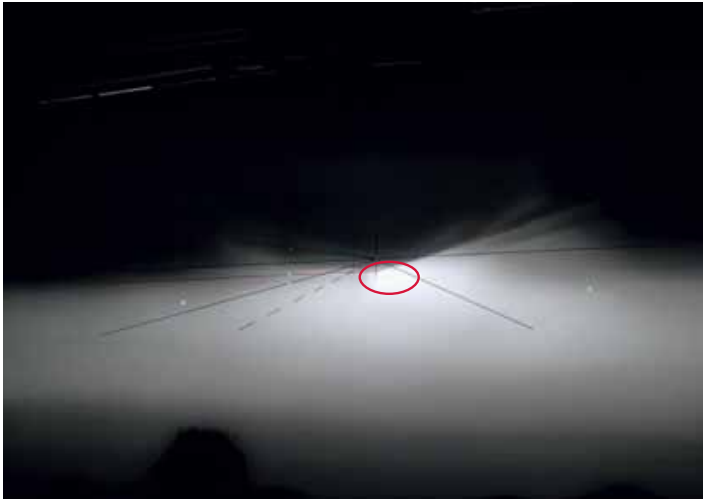
De rode lijn geeft aan tot waar het licht mag schijnen. De hotspot wordt door drie groene leds aangegeven. "Als een fabrikant aangeeft dat een lamp bijvoorbeeld 50% meer lichtopbrengst heeft, dan gaat het om de lichtopbrengst in die hotspot", zegt Melzer.
