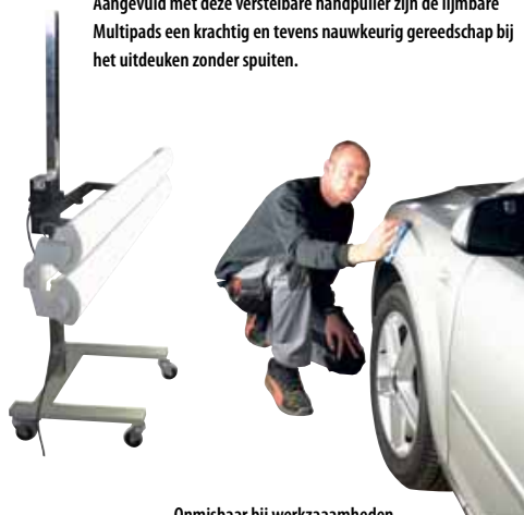
Onmisbaar bij werkzaamheden aan de carrosserie: goed licht. Met de verstelbare B TEC Sunny 01 belooft MSH daglichtkwaliteit.
