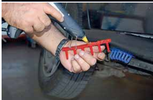
De Multipads-lijmset van MSH bevat onder meer vijf soorten multipads, lijm, een lijmstool en trekgereedschap.
