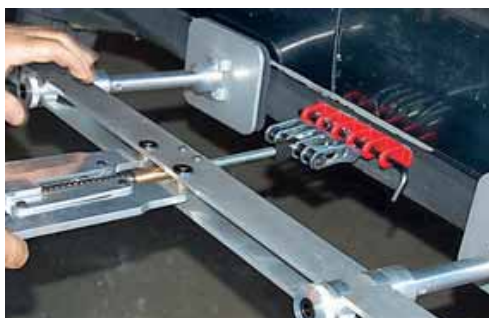
Aangevuld met deze verstelbare handpuller zijn de lijmbare Multipads een krachtig en tevens nauwkeurig gereedschap bij het uitdeuken zonder spuiten.
