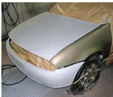
Rikus spuit de bumper bewust op zijn uiteindelijke plek om kleurverschil te voorkomen.
