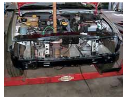
Daardoor sluit het nieuwe front netjes aan op de binnenschermen en langsbalken.
