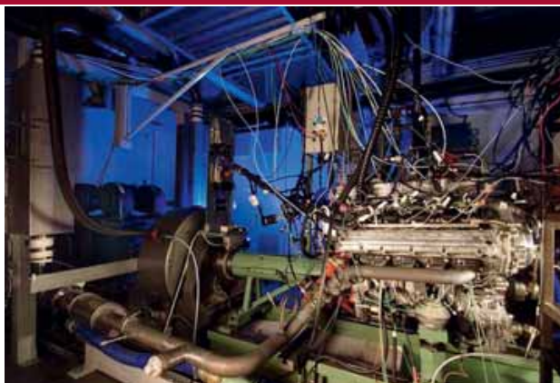
De UB100-proefmotor op de testbank, zonder compressoren eraan omdat de inlaatdruk extern werd geregeld om daarmee te experimenteren.
