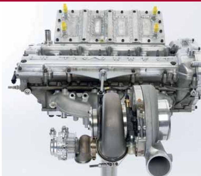
Deze opname toont dat de vloeistofgekoelde inlaatluchtkoeler na de compressor nog een experimenteel bouwstuk is. Ook de eerste tussenkoeler na de turbocompressor werkt met vloeistof.
