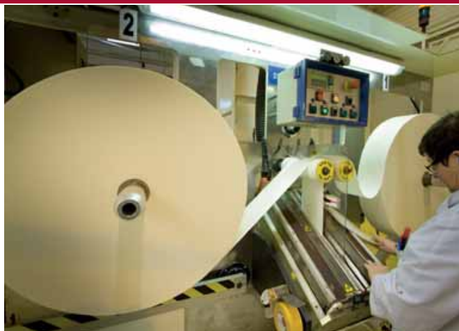
De rollen worden in stroken gesneden en gaan dan de vouwmachine in.
