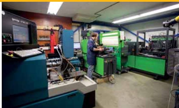
In de oudere testruimte kunnen alle soorten dieselpompen en (pomp)verstuivers van oudere generaties worden beproefd.
