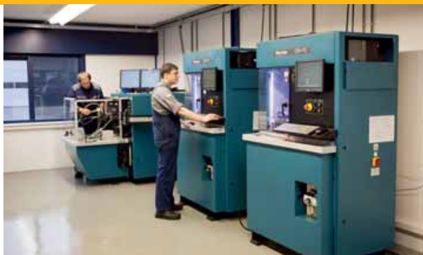
Smetteloze ruimte voor de common rail verstuivtesters, achteraan een testbank voor roterende dieselpompen.
