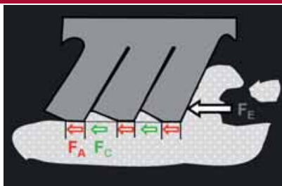
Grip op sneeuw bestaat uit drie elementen: Fe is de grip door het frees-effect van de lamelranden, Fc is de sneeuw-op-sneeuw grip en Fa de rubber-op-sneeuw grip.
