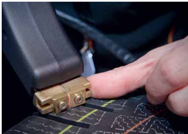
Handmatig wordt het door ons bedachte profiel in de band gesneden, zodat we kunnen proberen of het werkt.
