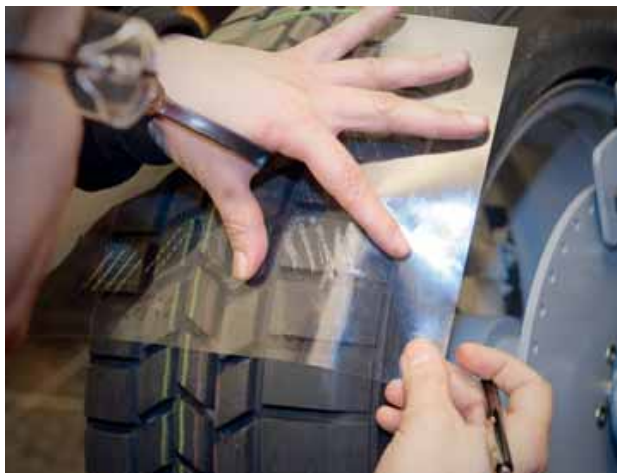
Alsof we er verstand van hebben tekenen we lamelgroeven af op de profielblokken van een testband.
