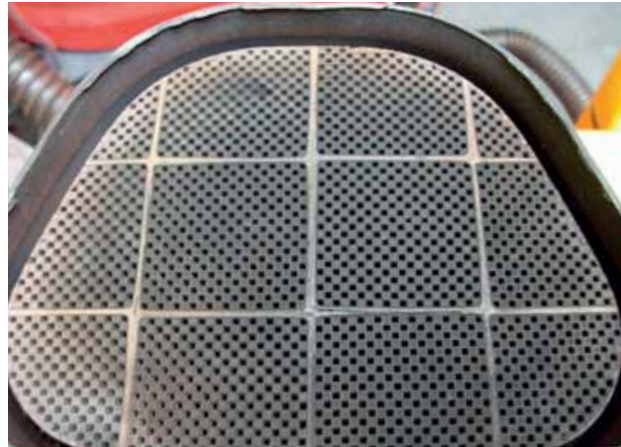
Na reiniging is dit het beeld. Topcats beschikt over een bestand met flowwaardes per merk en type roetfilter. Voldoet het filter na reiniging, dan krijgt het een groen label (voor akkoord) op het reinigingscertificaat.
