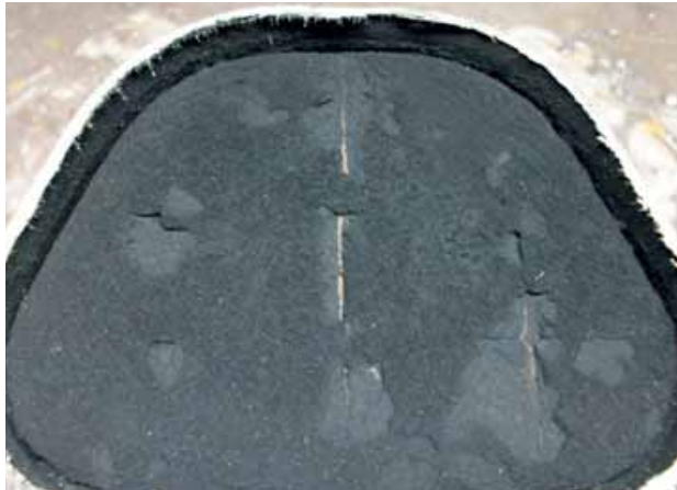
Voor reiniging kan een opengeslepen roetfilter er zo uitzien. Regenereren biedt hier geen uitkomst meer.
