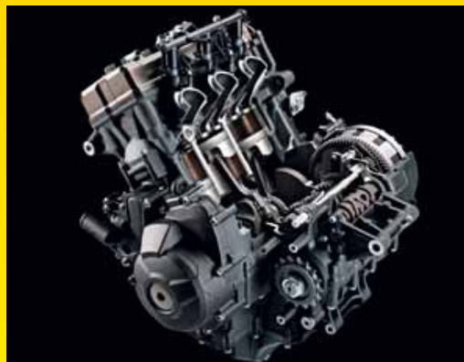
Supercompacte MT-09 driecilinder anno 2013. De boven elkaar liggende versnellingsbakassen bieden ruimte aan een lange achtervork, kleine klephoek voor compacte verbrandingskamers, in de cilinderkop gemonteerde injectoren en dankzij 0-ringen is de huidige ketting bijna net zo onderhoudsvriendelijk als de toenmalige cardan.
