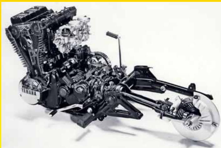
Motorfiets techniek anno 1976: luchtkoeling, twee kleppen per cilinder, carburateurs, contactpuntjes, genoeg massa om balansassen overbodig te maken en een kickstarter voor de zekerheid.
