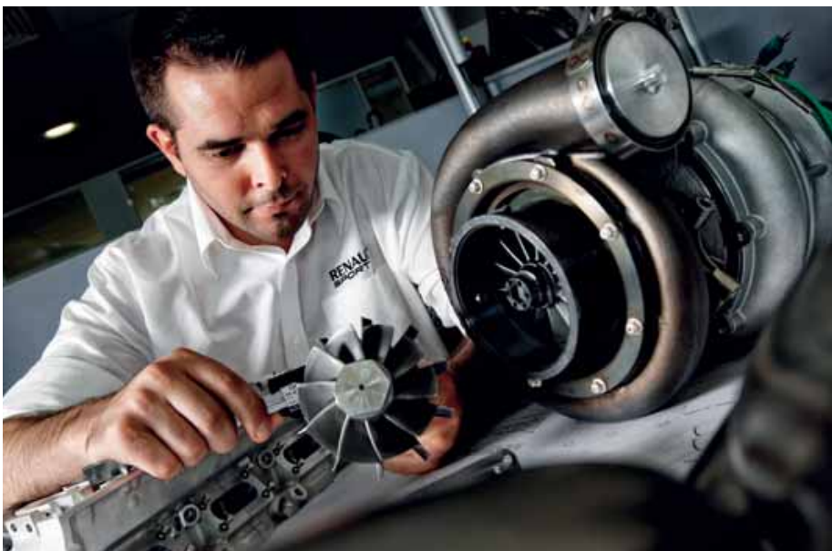
Een enorme turbo, vergeleken met productiemotoren. Maar hier gaat kennis verworven worden over de meest ideale geometrie van turbinewielen, neem dat maar aan!
