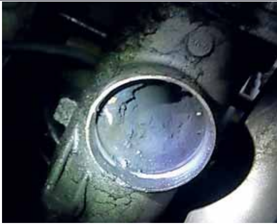
Voorbeeld 1: De EGR-klep was al vervangen, maar ook de EGR-koeler is zwaar vervuild. Hoe reken je af met die vervuiling én hoe voorkom je dat het opnieuw gebeurt?
