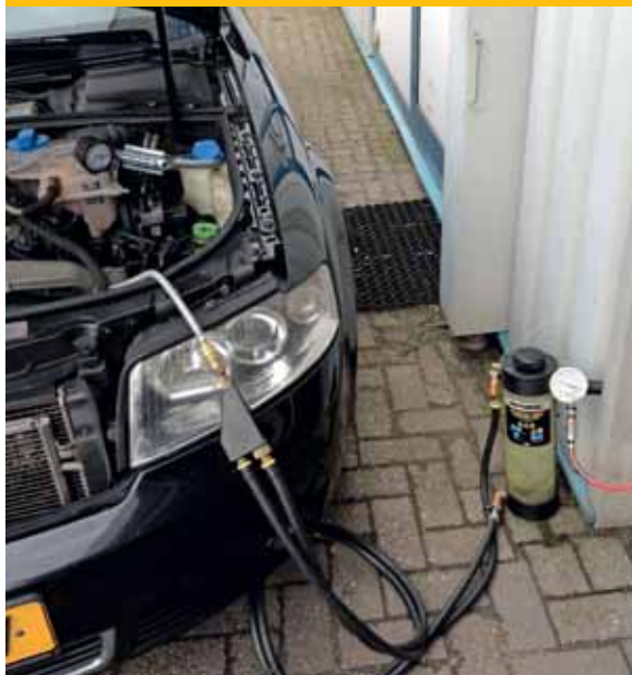
De MotorVac Diesel Systeem Reiniger vult het inlaatkanaal onder hoge druk met een reinigend schuim. Dat werkt beter in op koolafzetting en verkleint de kans op waterslag.
