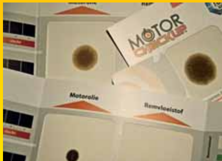
Zit er veel vuil, water of brandstof in de olie? Een testje met MotorCheckUp laat het zien. Tijdig actie nemen, kan veel motorellende voorkomen.
