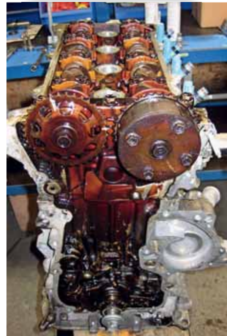
Voorbeeld 4: Lakafzettingen op zuigers en cilinderwanden ontstaan als de motor zelden of nooit op temperatuur komt. Maar deze Toyota VVTi-motor is bruin van top tot teen. Zijn daar niet juist hoge temperaturen voor nodig? Kortom, hoe ontstaat deze vervuiling?
