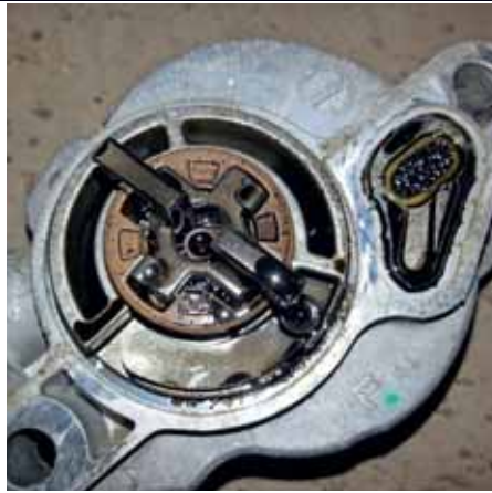
Voorbeeld 2: Turbo defect en het gruis door de hele motor, van het zeeffje van de vacuümpomp tot in de carterpan. De olie was al lang niet ververst en de computer gaf al langere tijd aan dat het roetfilter vervangen moest worden...
