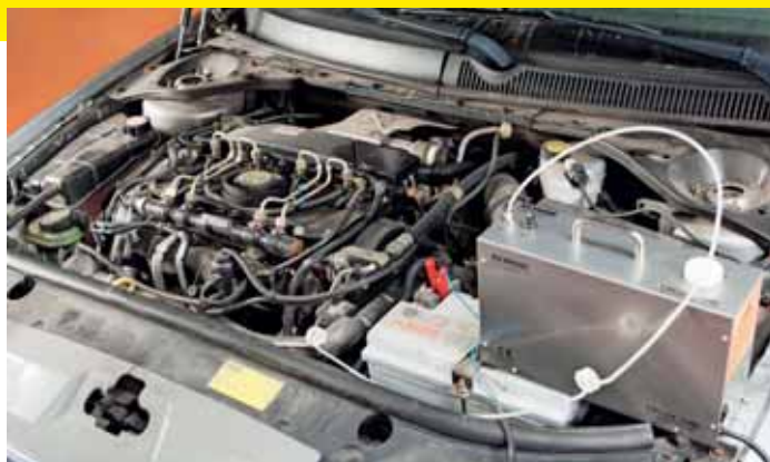
De Xenum I-Flux reinigt de inlaatzijde van de dieselmotor. Het apparaat voert de reinigingsvloeistof gedoseerd toe. Xenum adviseert het bij de verstopte EGR-koeler uit voorbeeld 1.
