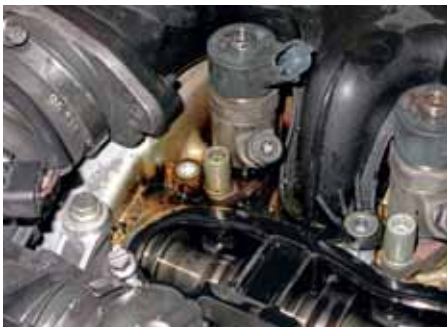
Voorbeeld 2, de Peugeot HDI (DV-6) eindigt met een defecte turbo, maar begint met een slechte verbranding door vervuilde of lekkende verstuivers, legt Forté uit in een technisch bulletin. Lekkage langs een verstuiver is de eerste indicatie.
