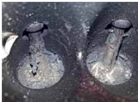
Voorbeeld 3: Vuilopbouw op de inlaatkleppe leidde tot compressieverlies, cilinderoverslag en uiteindelijk een defecte katalysator.
