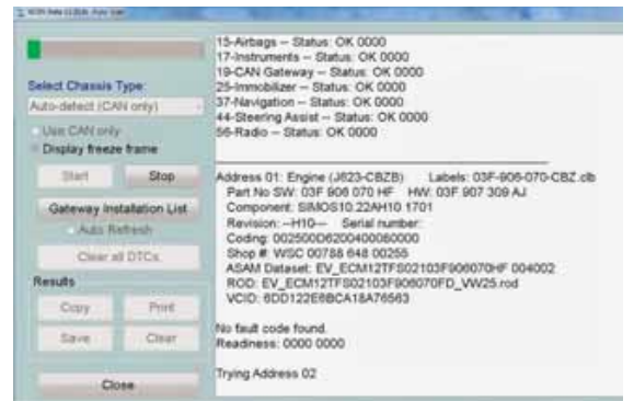
De auto-scan functie helpt om snel een overzicht te krijgen van alle aanwezige foutcodes.
