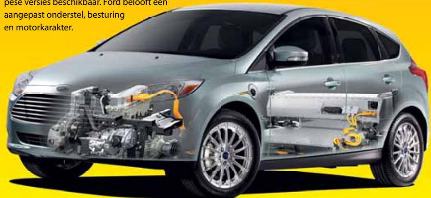
De Ford Focus is niet echt berekend op een elektrische versie. Het accupakket steekt hoog in de bagageruimte, onder de vloer en in de middentunnel is geen plaats genoeg.
