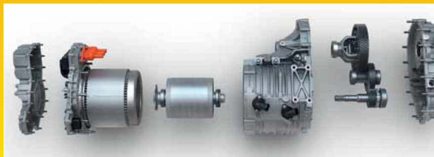
Eigenlijk een simpel ding, zo'n elektromotor. Rechts de tandwielreductie met differentieel, dan het huis met koelvloeistof-aansluitingen, de rotor met permanente magneten en links de elektrisch bekrachtigde stator.
