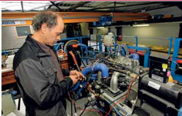
De testbanken worden gebruikt om nieuwe aandrijvingen op de proef te stellen, maar ook om gegevens te verzamelen voor simulaties.
