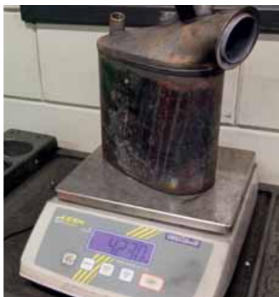
Een gereinigd filter blijkt 38 gram lichter te zijn geworden.
