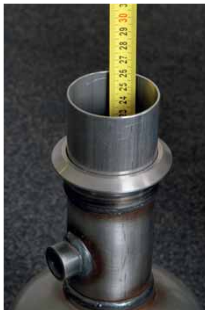
Filtermateriaal is duur. Door het c.a. 7 centimeter korter te maken, bespaart de fabrikant naar schatting tussen de € 50,- en € 100,-.
