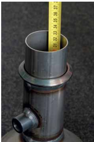
Hoe langer het filter, hoe beter de luchtdoorstroming en des te groter de capaciteit. Dit filter is goed.
