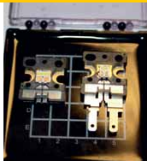
Lastig zichtbaar maar alles draait om de gele stipjes. Links een ledmodule met vier leds, rechts met twee leds. Alles er omheen is voor stroomtoevoer, koeling en montage.
