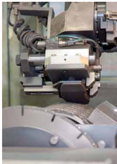
Shims, en het afkanten van remblokken, zoals hier in de Ferodo-fabriek in Mondovi, zijn beproefde middelen om tot stillere, comfortabelere remblokken te komen.
