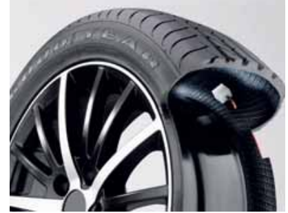
Een sensor in de band meet de bandenspanning en past die zo nodig aan via de in het rode luchtslangetje opgebouwde druk.
