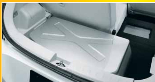
Het accupakket zit in de kofferruimte.
