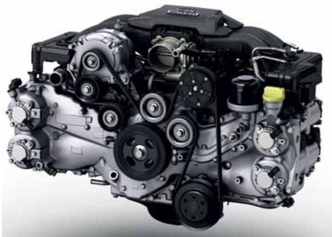
De Subaru/Toyota boxer FA is afgeleid van de FB. Door aanpassing van in- en uitlaatkanalen en het carter heeft hij maar weinig inbouwhoogte nodig. Dat verlaagt het zwaartepunt van de coupé.
