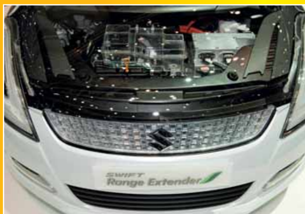
Onder de plasticen kap zit volgens Suzuki een driecilinder benzinemotortje, een generator en elektromotor.
