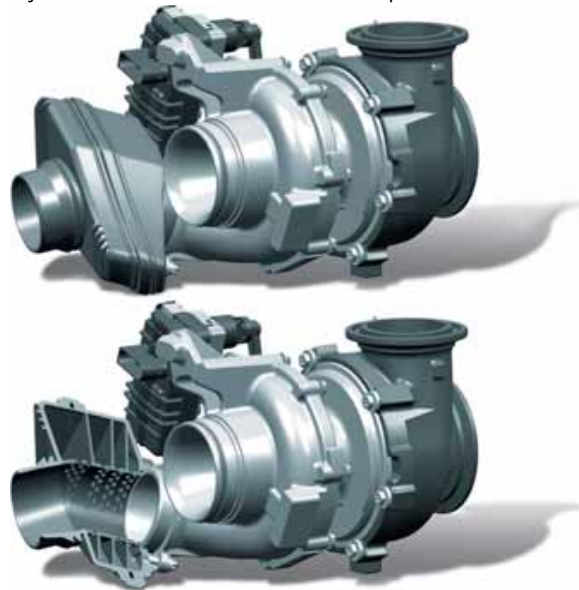
De compactere en lichtere turbocompressor heeft lagers met minder wrijving, daardoor komt de inlaatdruk sneller tot stand. Dat zorgt voor een verbetering van het dynamisch rijgedrag. De meerkamer geluiddemper heeft een breed frequentiebereik om de akoestiek zo aangenaam mogelijk te maken.
