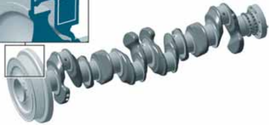
Er is een verzwaarde uitvoering van de torsietrillingsdemper ontwikkeld omdat de krukas, door het weglaten van vier van de acht contragewichten, een lager massastraagheidsmoment (vliegwielerwerking) heeft.
