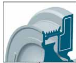
Er is een verzwaarde uitvoering van de torsietrillingsdemper ontwikkeld omdat de krukas, door het weglaten van vier van de acht contragewichten, een lager massastraagheidsmoment (vliegwielerwerking) heeft.
