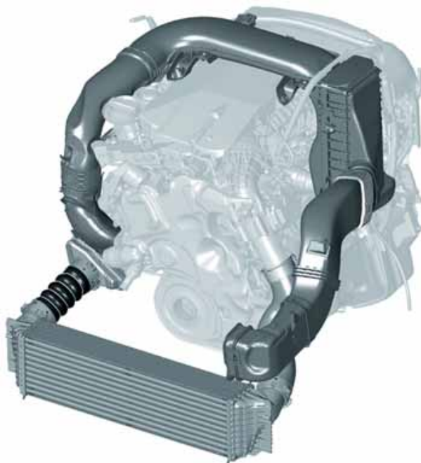
Door zoveel mogelijk onderdelen van het luchttoevoersysteem star met de motor te verbinden hoeft er voor alle automodellen maar één systeem te worden gebruikt. Alleen de aanzuigleiding naar het inlaatluchtfilter wordt aan het model aangepast.
