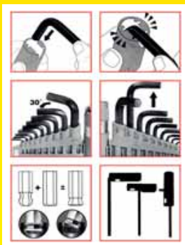
De powergrip maakt van een inbus een multifunctioneel stuk gereedschap.
