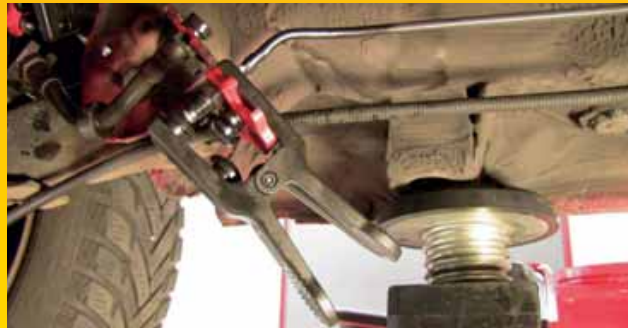
De All-in-one vloeistofstopper is geschikt voor het afsluiten van leidingen met een diameter van 4 tot 12,7 mm.
