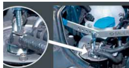
Vervanging van het brandstoffilter kost € 200,-. Treedt de lekkage achteraf op dan lekt de brandstof over de multi-V-riem en kan de schade hoger oplopen. De Kraftstoffilterdeckel Montagehebel UFI kost € 105,- ex BTW.
