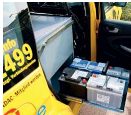
De ADAC-wegenwachter heeft verschillende reserveonderdelen bij zich. Ter hoogte van de achterdeuren bevinden zich links en rechts lades met verschillende standaard batterijen. Het aannemen van nieuwe batterijen doet de ADAC-wegenwachters nog niet.
