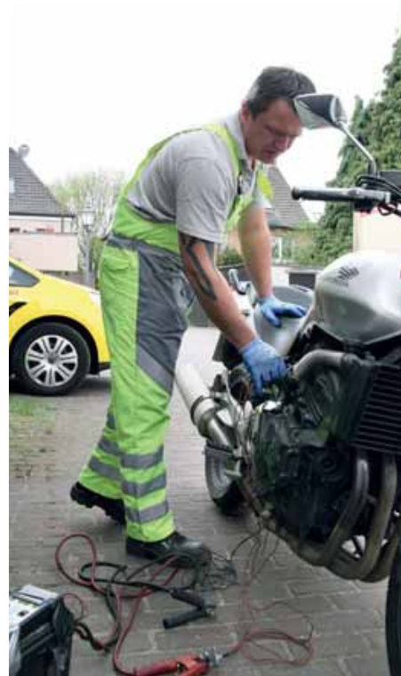
De ADAC helpt alle soorten voertuigen. Voor motorfietsen gebruikt Möschler kleinere accuklemmen.
