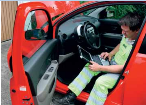
Een brandend motorstoringslampje na een onderhoudsbeurtje. Wat is er aan de hand? Uitlezen geeft foutcode P0301, misfire eerste cilinder.
