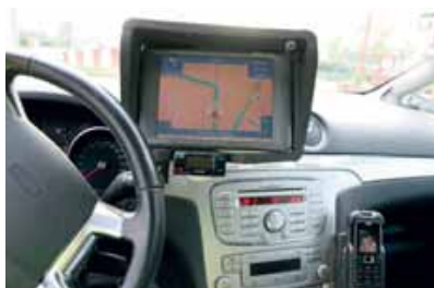
Via een computer op het dashboard krijgt de wegenwachter alle opdrachten binnen. Het navigatiesysteem laat de route naar een pechgeval zien. Als de wegenwachter aangekomen is, geeft hij dat door aan de centrale.
