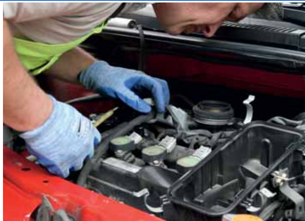
Michael Möschler controleert de aansluitingen van de bobines. De stekker van de eerste cilinder zat niet vastgeklikt. Maar ook daarna kwam de storing weer terug.
