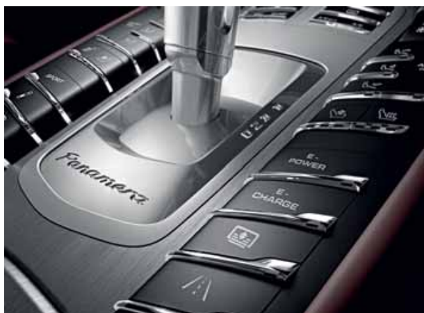
E-power mobiliseert beide krachtbronnen maximaal, e-charge laadt de batterij onderweg slim op, zodat behalve het eerste ook het laatste deel van een langere rit emissievrij is af te leggen.
