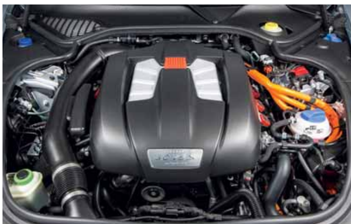
Goedgevulde motorruimte met hoogspanningskabels, de omvormer en regeltechniek rechts voorin.
