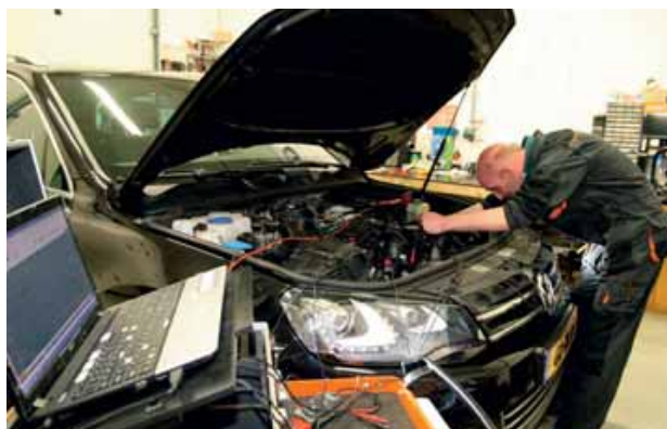
Deze Touareg heeft een te hoog brandstofverbruik. Om de oorzaak te achterhalen, vergelijkt Doosje de waarden van de computer, die hij uitleest via de diagnoseapparatuur, met de waarden die hij meet via de vierkanaals GMTO-scope.
