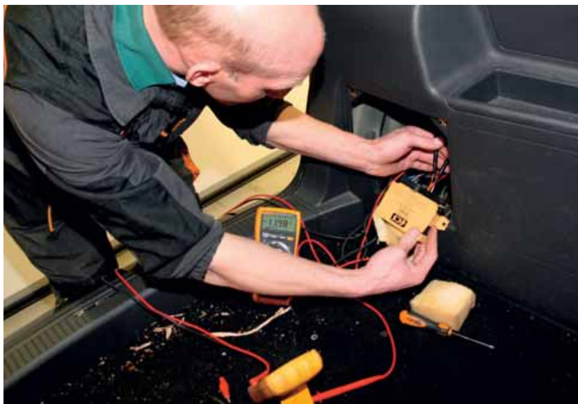
"De stekkerdoos van deze VW Touran werkt niet goed. Werkt de trekhaakmodule wel goed? Meten is weten", zegt Doosje.
