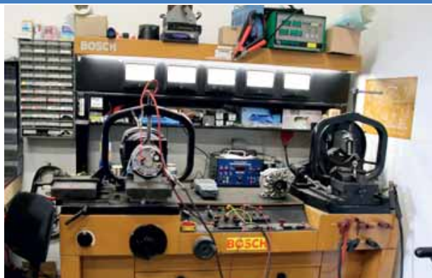
Voor het testen van startmotoren en dynamo's heeft Novatech ook de juiste apparatuur in huis. "Het is al een oud beestje, maar hij functioneert nog prima", zegt eigenaar Hoekstra.
