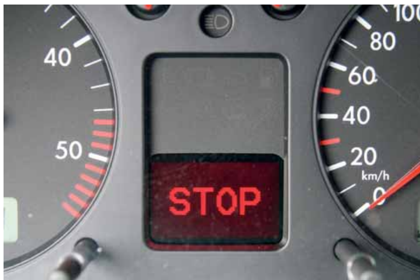
Echt of fake? Door overbelasting van de CAN-bus komen berichten niet of te laat aan. Daardoor ontstaan storingen.
