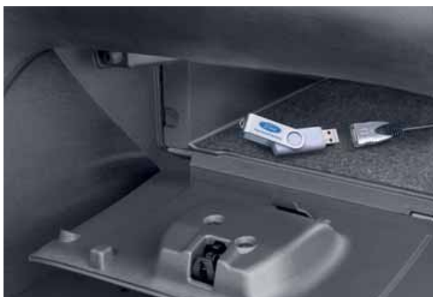
Een moderne auto heeft verschillende ingangen. Alleen al het multimedia- en navigatiesysteem beschikt over een DVD-speler, USB-aansluiting, Bluetooth-verbinding en SD-kaartlezer. Gelukkig zijn deze systemen meestal gescheiden van de CAN-bus.
