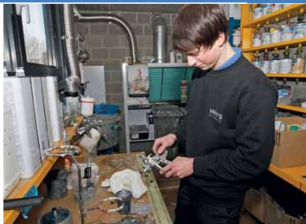
In het verflabo wordt op basis van de kleurcode voor elke auto de juiste lak gemengd.
