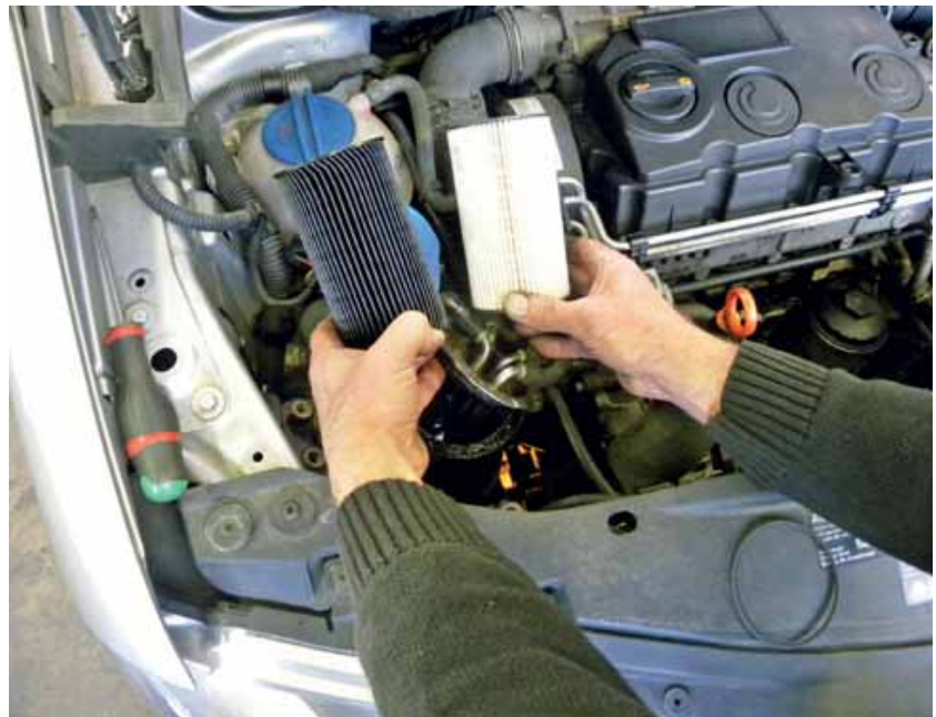
Een sterk vervuild brandstoffilter duidde op een lekkende tandpomp. Een foutje bij demontage van de stekkers zorgde ervoor dat de autotechnicus vastliep.
