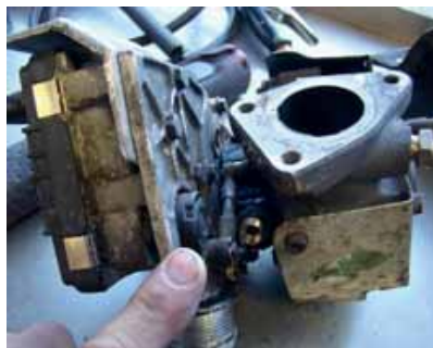
Een sterk vervuild brandstoffilter duidde op een lekkende tandpomp. Een foutje bij demontage van de stekkers zorgde ervoor dat de autotechnicus vastliep.
