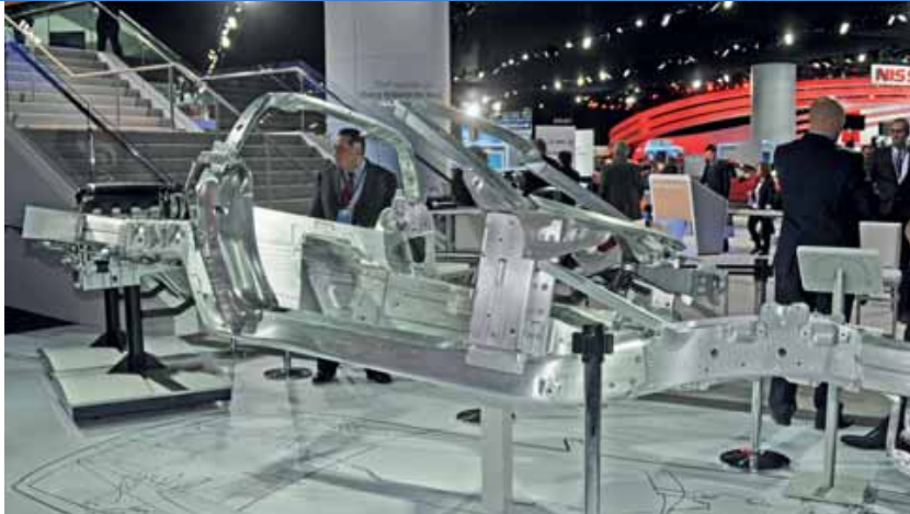
We herkennen in het Corvette frame veel van de aanpak van Ferrari: een combinatie van gegoten en geperste delen die zijn verwerkt met lassen, pognagels en verlijmded verbindingen. Het geheel is 76 kilo lichter, maar toch meer dan de helft stijver geworden.
