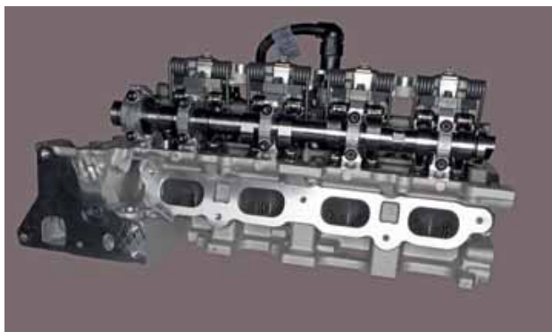
Vanaf de inlaatkant gezien is het duidelijk dat de Valvetronic klepbediening flink veel ruimte inneemt. We zien de haarspeldveren die de speling in het stelmechanisme voorkomen, een soort "hulpklepveren". We kijken tegen de as aan met de stelnokken die het kleplichthoogte wijzigen. Let op de ovale inlaatpoorten.
