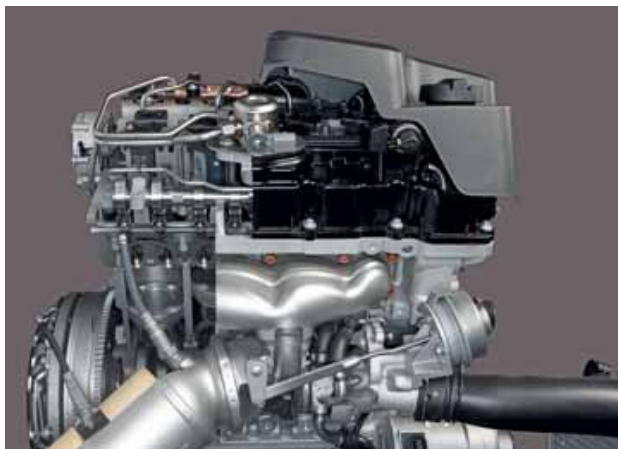
De nokken zitten aan weerszijden van de lagerbokken met de hydraulische stelpluniers helemaal aan de rand van de cilinderkop. De zuigers hebben een ondiepe kom met niet al te diepe klepuitsparingen. Het is duidelijk dat de turbocompressor heel compact is.
