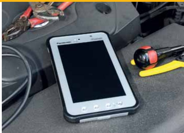
De JT-B1 weegt maar 544 gram, is compact en is dankzij een draagband makkelijk te vervoeren. Deze Toughpad heeft een beeldscherm van zeven inch.
