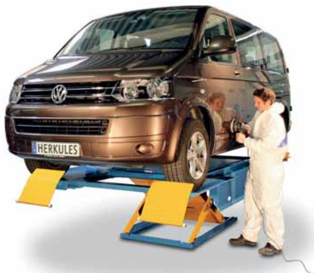
Overlander beveelt deze Herkules brug aan, waarbij de schadehersteller tijdens voorbereiding en afwerking kan staan en niet hoeft te bukken. Werkt prettiger, sneller en is langer vol te houden, dus efficiënter.
