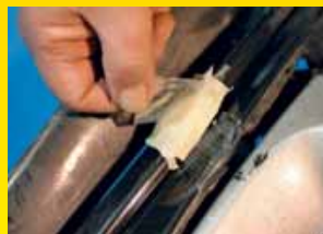
De UV Patch reparatiepad is een flexibel reparatiemiddel, van glasvezelversterkt polyëster. De pad is zeer eenvoudig te verwerken.
