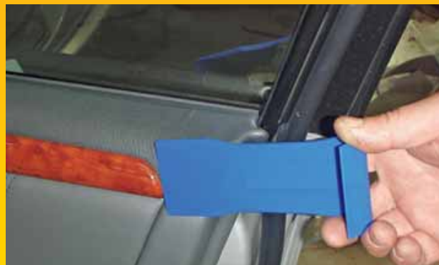
Een set van vijf bekledingsvorken is geschikt voor het krasvrij oplichten of losmaken van sierlatten, sierstrips, afdekplaatjes e.d.
