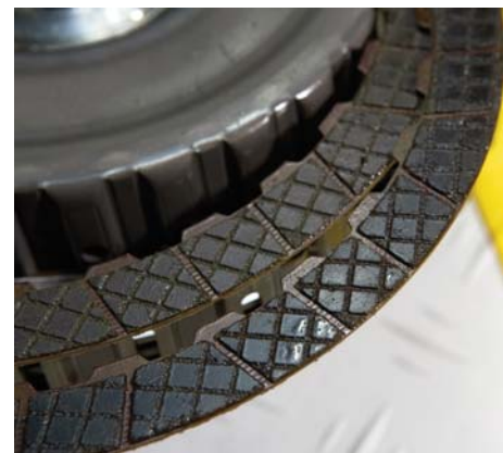
Versleten (boven) en goede koppplingsplaten. Veelvuldig schakelen onder zware belasting, bijvoorbeeld het rijden met een caravan in de bergen waarbij de bak constant aan het open en terugschakelen is, vraagt veel van de koppplingsplaten met als gevolg extreme warmte-ontwikkeling en dus slijtage. U herkent ze aan de kleur waarbij de lichtere (boven) zijn versleten.
