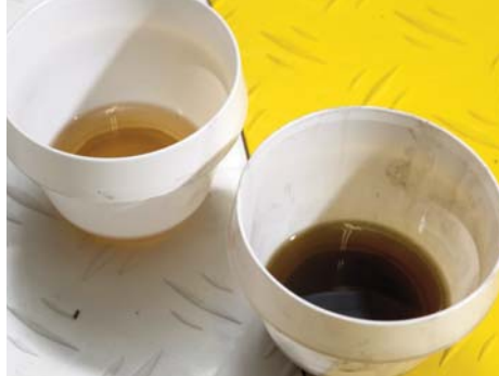
De olie uit het voorste bekertje heeft blootgestaan aan extreme hitte. Volgens Ronald Logmans geeft dat een aardige indicatie van de staat van de bak. In dit geval slecht dus.
