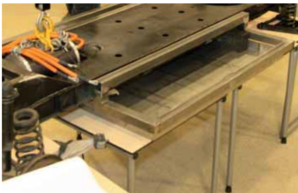
De accubak steekt aan weerszijden uit en is onder het chassis bevestigd. De bovenkant van de bak wordt afgedekt en dient dan als treeplank.
