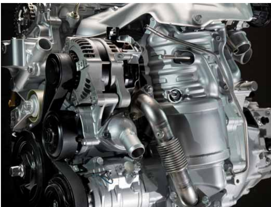
Honda gebruikt zowel hoge- als lagedruk EGR, we zien hier de lagedrukpijp lopen die uitlaatgas na katalysator/roetfilter terugvoert naar de inla
