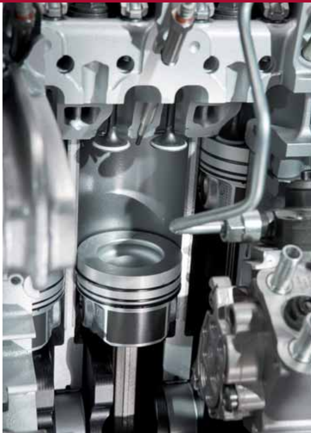
De zwarte DLC (Diamond Like Carbon) coating op het zuigerhemd is een van vele maatregelen om de interne wrijving te verlagen tot hetzelfde niveau als in een benzinemotor.
