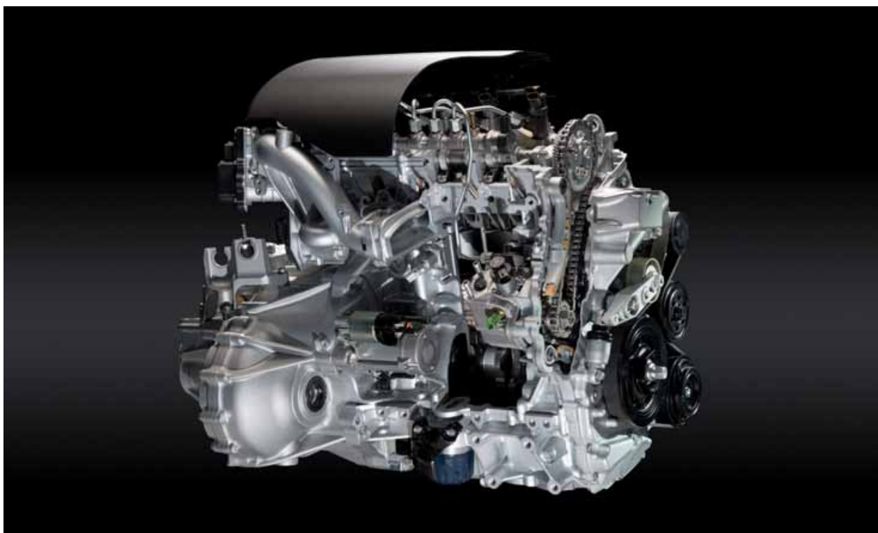
Ongebruikelijke oplossing om de motor korter te houden: een ketting van krukas naar hogedrukpomp en van daaruit een ketting naar de inlaatnokkenas.
