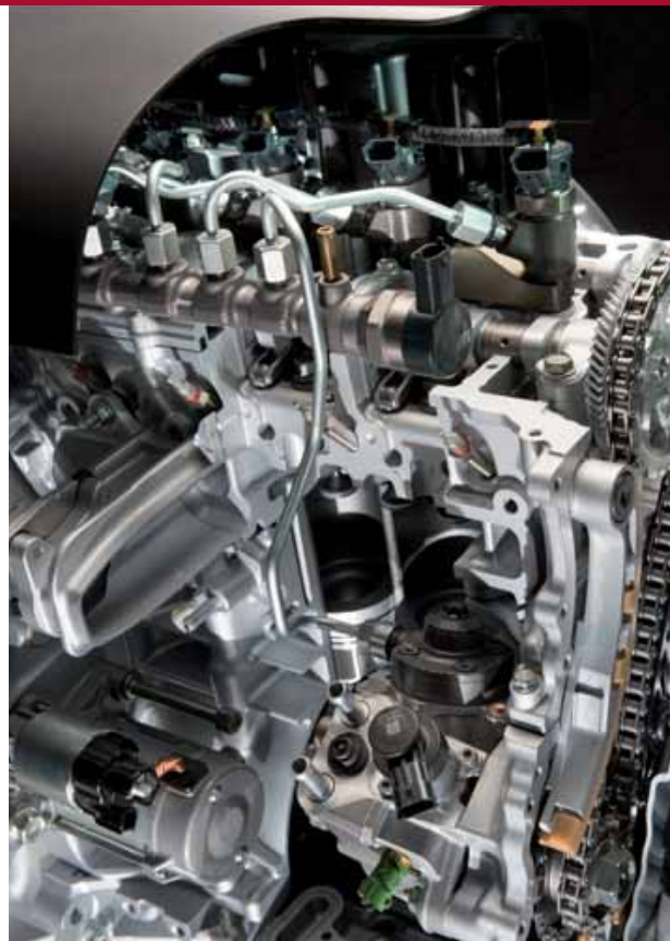
Rechte inlaatkanalen en een schot tussen beide inlaatpoorten van een cilinder moeten meehelpen aan optimale cilindervulling, ook bij laag toerental.
