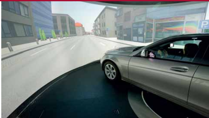
De nieuwe S-Klasse virtueel testen in de grote simulator van de ontwikkelingsafdeling? Intrigerend is het zeker, maar het vereist een sterke maag.
