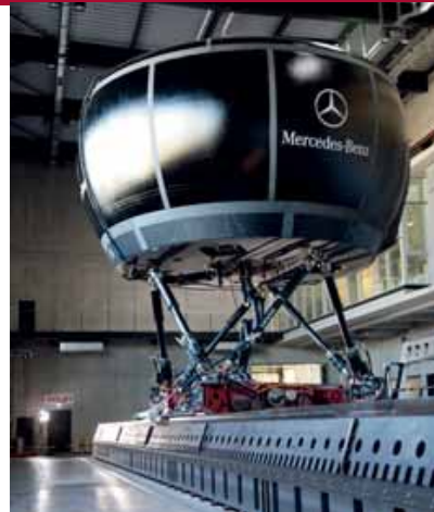
De hele simulator beweegt twaalf meter naar links en naar rechts met een maximale snelheid van 10 m/s. Dat maakt uitwijkmanoeuvres meer dan levensecht.
