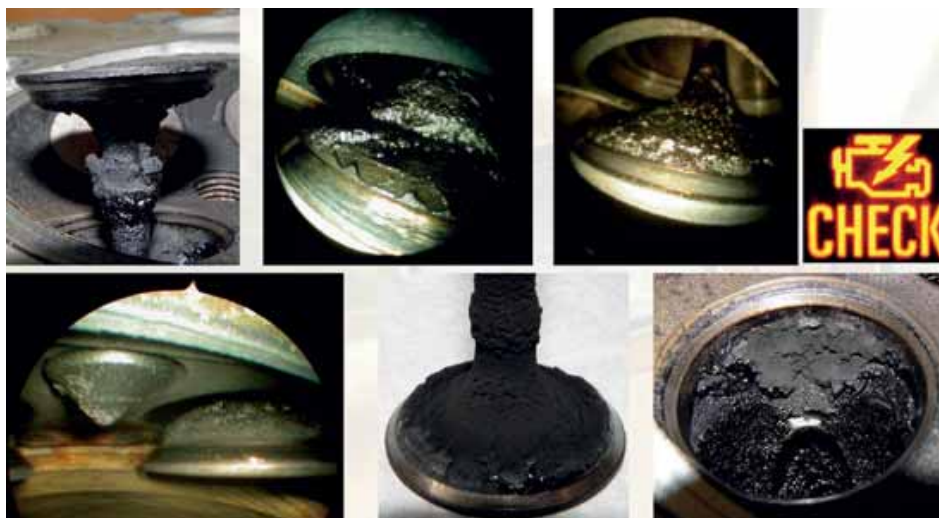
Met foto's toont Van de Ven de gevolgen van vervuiling. Een zwarte tint voert de boventoon bij de foto's van DI-inlaatklepvervuiling.
