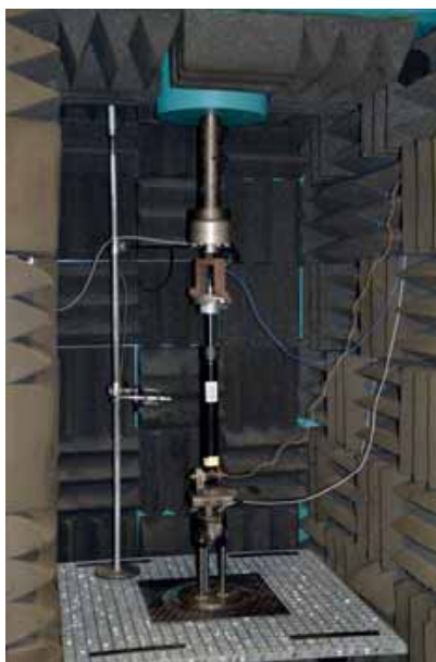
In de Noise Chamber test Monroe schokdempers individueel. De demper doorloopt een testcyclus waarbij een microfoon alle geluiden registreert.
