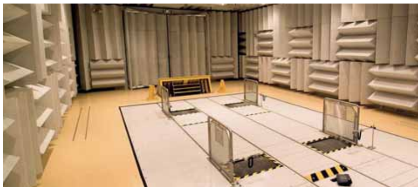
De Noise Room is een los gebouw in het Monroe European Technical Centre. Daardoor hebben geluiden van buitenaf geen invloed op de metingen. In de ruimte is elke schokdemper onder een voertuig apart te testen.
