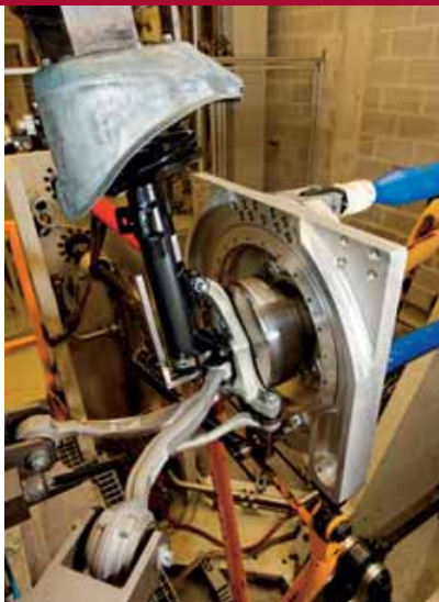
Bij de one cornertest kan Monroe de schokdemper in alle richtingen belasten. Hiermee kunnen dus ook rem-, stuur- en gasreacties gesimuleerd worden.
