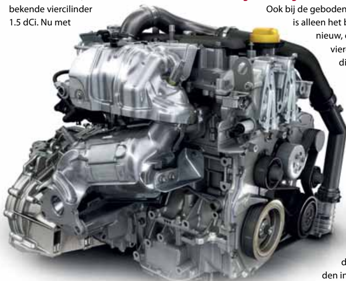
Uitlaatzijde van de 1.2 turbo viercilinder. Renault haalt de uitlaatgasrecirculatie op lagere druk en temperatuur weg na de katalysator, in plaats van zoals gebruikelijk direct bij de uitlaatpoorten.
