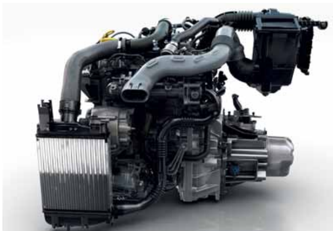
Verwacht wordt dat de zeer compacte TCe 90 driecilinder met turbo tot de populairste motorversies zal behoren. Net als de collega's van Peugeot/Citroën houdt Renault het bij de nieuwe driecilinder nog op injectie in de inlaatpoorten, waar Ford en Volkswagen gaan voor directe injectie vanaf de kleinste motoren.
