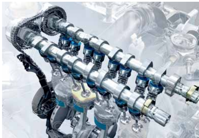
Twee verstelbare nokkenassen op de nieuwste viercilinder 1.2, met onderhoudsvrije kettingaandrijving zoals ook toegepast in de 0.9 driecilinder.
