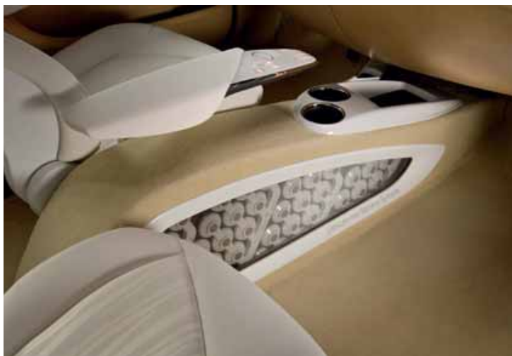
Een toekomstblik van Johnson Controls, met Li-ion batterijen in de middenconsole van een elektrische auto. Nu maakt Johnson Controls/Saft ronde cellen, in 2015 komen er platte cellen.
