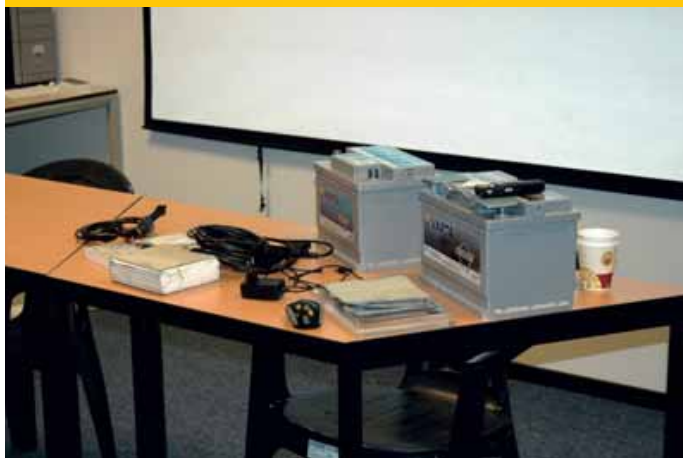
De Varta EFB (zwart) en AGM (blauw) stop-startaccu's; het witte pakketje aan de linkerzijde is een set accuplatten met glasvezelhulling.
