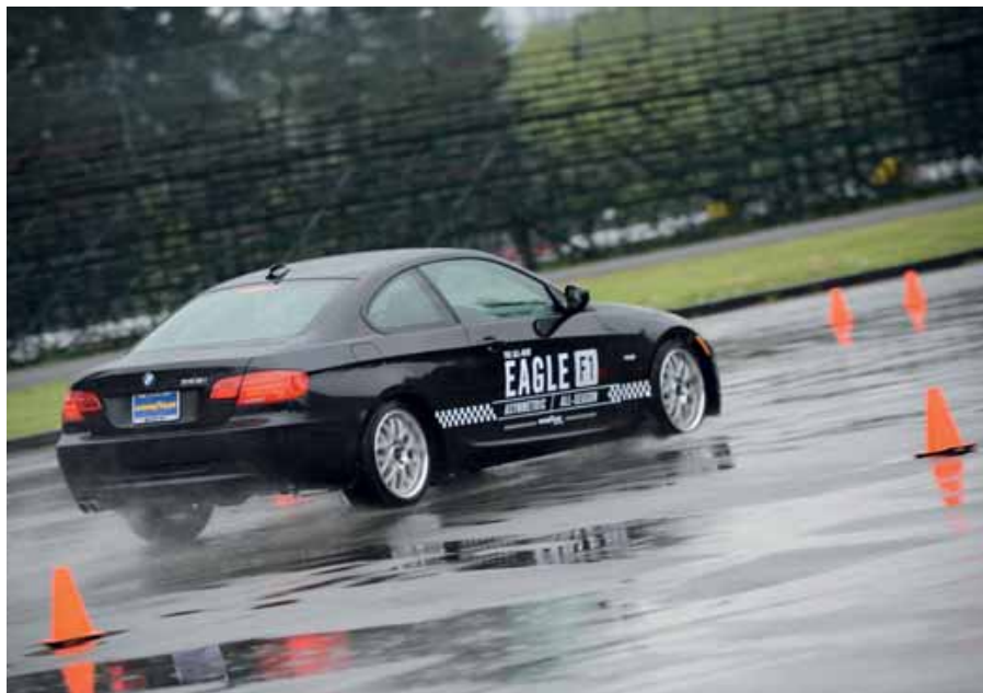
Natte grip wordt voor het bandenlabel gemeten met een ABS-noodstop. Daarin is een winterband met lamellen in het profiel iets minder dan een zomerband, zeker als niet gemeten wordt bij lage temperatuur tegen het vriespunt maar bij 20 graden.
