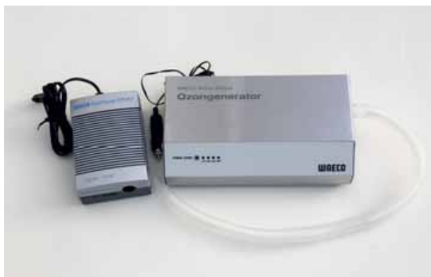
De ozongenerator van Waeco kan via het boordnet werken, maar kan ook op de optionele netvoeding worden aangesloten. Afhankelijk van de vervuiling kan het apparaat in stappen van een kwartier tot een uur lang reinigen. De ventilator van de auto moet daarbij op de laagste stand staan en de recirculatieknop moet ingeschakeld zijn. Na reiniging de auto laten luchten om overtollige ozon te laten ontsnappen.
