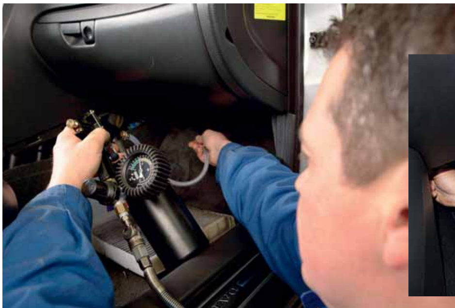
Een vervuilde verdamper reinigen we vroeger met een flinke hoeveelheid reinigingsmiddel, aangevoerd via een drukkokerpistool met lans en een gerichte sonde.
