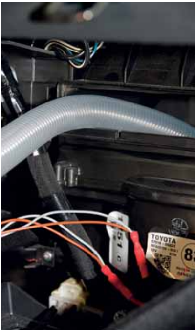
Bij deze Toyota Avensis zit het interieurfilter achter het dashboardkastje. Als het oude interieurfilter eruit is gehaald, kan de slang van de Waeco-ozongenerator in het filterhuis worden gestoken.
