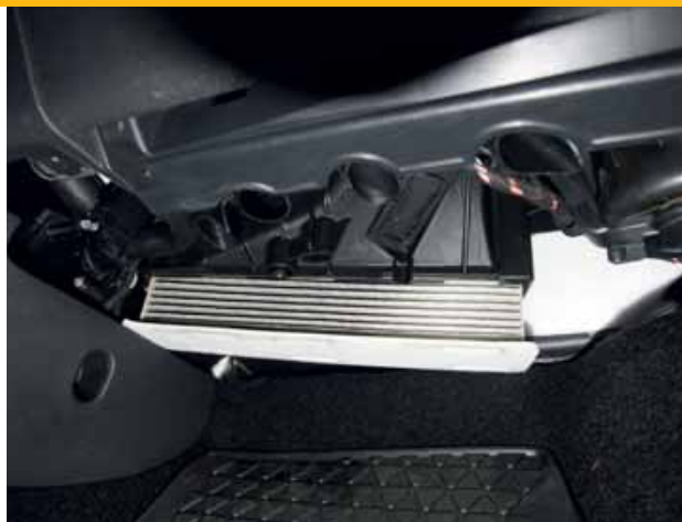
Bij de Volkswagen Tiguan zit het filterhuis onder het dashboardkastje. Het reinigingsmiddel wordt bij de Tiguan via de opening van de temperatuursensor verneveld. Diverse leveranciers hebben informatie beschikbaar over de manier waarop je, per type auto, de reiniging het best kunt uitvoeren.
