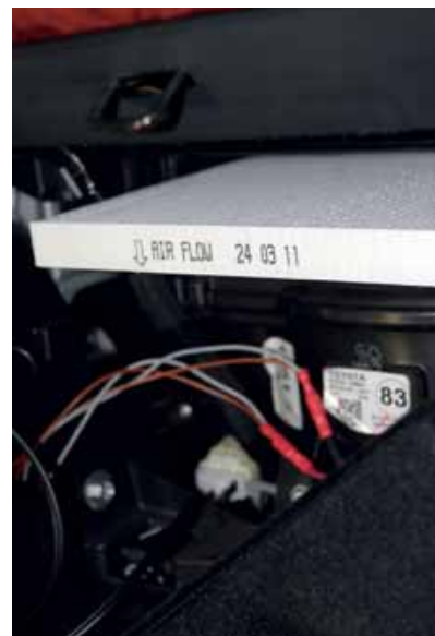
Let bij het aanbrengen van een nieuw interieurfilter op de juiste montage. De richting van de luchtstroom staat aangegeven.
