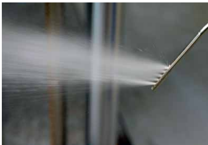
Verdampers zijn meestal lastig bereikbaar. Bij een drukbeker hoort daarom een flexibele sonde met meerdere uitstroomopeningen.
