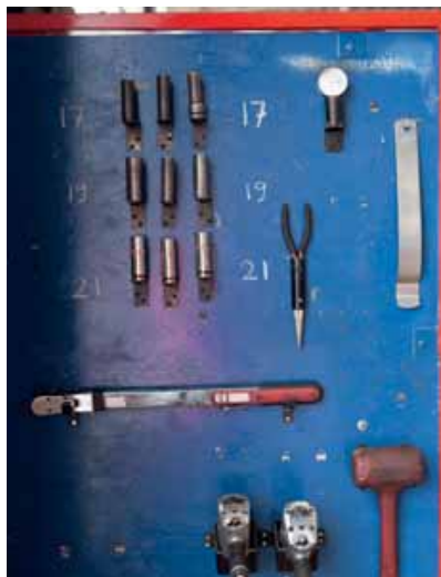
De pilot Levensfase Bewust Personeelsbeleid maakte duidelijk dat er extra geïnvesteerd diende te worden in gereedschap, want in de oude situatie liepen de monteurs te veel heen en weer. Met extra gereedschapskisten en gereedschapborden bleken de werkzaamheden veel efficiënter te worden uitgevoerd. Op de blauwe borden hangen onder andere een momentsleutel, een profielmeter, een bandenlepel en twee slagmoersleutels. Dat voorkomt zoeken en heen en weer lopen.
