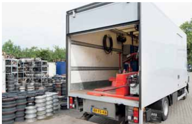
In de compacte ruimte van de service-auto staan een geïsoleerd aggregaat, een compressor en een nieuwe krik. Er is water en zeep, interactieve ledverlichting en er zijn handvatten voor makkelijk in- en uitstappen. Balanceren van landbouw- en truckbanden komt zelden op locatie voor, maar indien nodig wordt er met sulfaatpoeder gebalanceerd. De service-auto is grotendeels ontworpen door Albert Kolkman, die ook verantwoordelijk is voor de pechservice.
