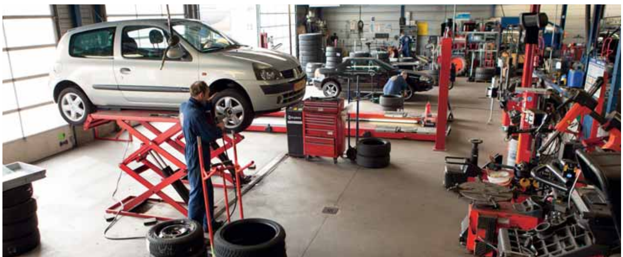
Achter de schaarlift staat een uitlijnbrug, die extra lang is voor Sprinters en VW LT's. Een uitlijncontrole kost een paar minuten. Henk Vermeulen: "We doen tien procent meer uitlijningen dan vorig jaar, dankzij de uitstraling van de equipment en de alertheid van de monteurs. Ook dealerbedrijven laten hun auto's hier uitlijnen. Wij moeten gemiddeld vier uitlijningen per dag doen en dat lukt".
