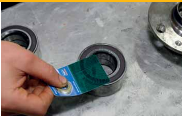
Met een speciaal kaartje is het magnetisch veld van de ABS-ring in het lager zichtbaar. Op de afbeelding is een afwijking in de ring zichtbaar.
