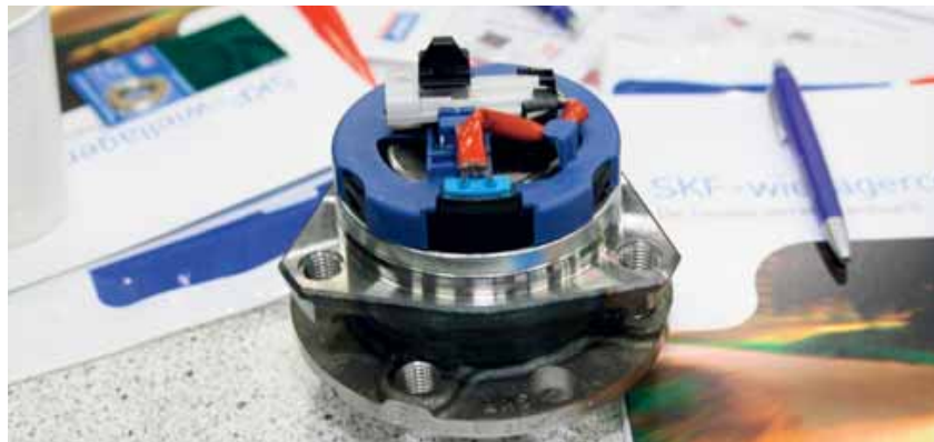
Dolph Amsing waarschuwt voor de kwetsbaarheid van ABS-sensoren en bedrading: "Monteer het lager, sluit de stekker aan en demonteer dan pas het blauwe kapje."
