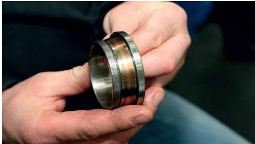
Onjuiste smering leidt tot oververhitting. Daardoor verkleurt het staal.
