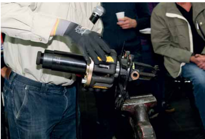
Johan van Doornik demonstreert de hydraulische cilinder van Wallmek. De cilinder heeft een perskracht van zestien ton.
