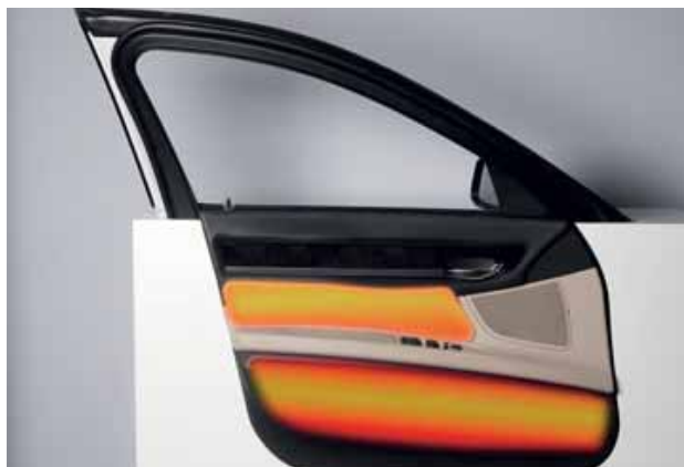
Bij lage buitentemperaturen gaat een behaaglijk interieur in een elektrische auto nogal fors ten koste van de actieradius. Infrarood straalverwarming kan dat effect verminderen.
