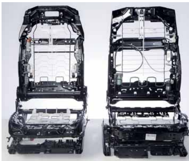
Stoelframe, links nieuw, rechts oud. Onder meer door de hoogte- en rugleuningsverstelling te ontkoppelen is het linkerframe 15% lichter.
