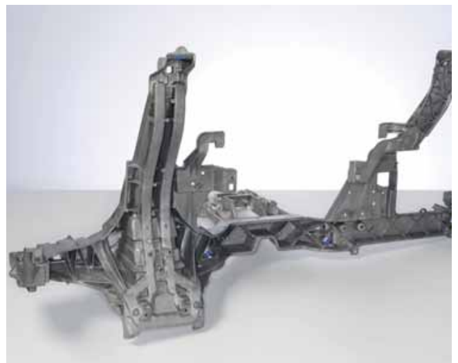
Magnesium dashboarddrager. Wat hier de onderkant is, is in de auto naar de inzittenden toegekeerd. Door materiaal en constructie is deze drager 30% lichter dan een traditioneel exemplaar.
