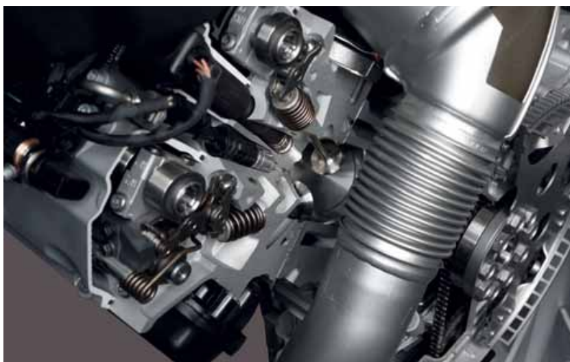
Woekeken met de ruimte in de cilinderkop. Centraal tussen de vier kleppen vond BMW nog ruimte voor zowel bougie als injector. Let op het Valvetronic-mechaniek tussen nokkenas en inlaatklep.
