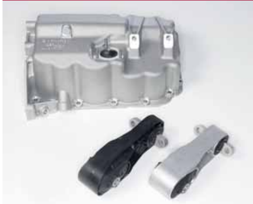
Kunststof motorsteun, ontworpen voor bevestiging op het mechanisch meest gunstige punt: onderaan het carter.
