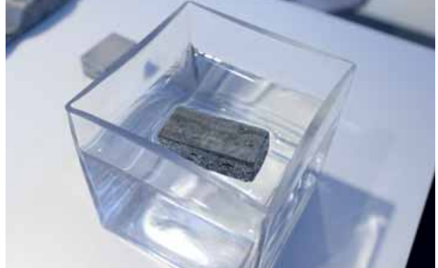
Zinkschuim is licht genoeg om in water te blijven drijven. Als vulmateriaal in bijvoorbeeld een aluminium profiel vergroot het de stijfheid van een constructie.
