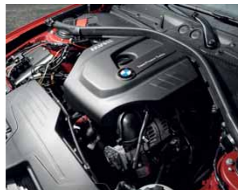
Driebcilinder in een BMW 1 Serie. De motorafdekplaat is een maatje te groot en tussen radiator en motor is nog een zee van ruimte. Bij dwarse plaatsing is de geringe inbouw lengte een groot voordeel. Zeker bij een hybride.
