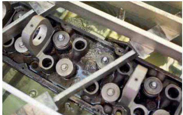
Door oververhitting kunnen de kleppen niet meer perfect afsluiten of kunnen er haarscheurtjes in de kop komen. In dat geval is koprevisie noodzakelijk.
