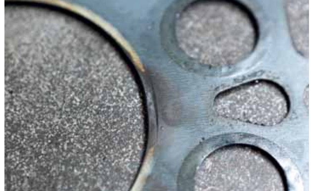
Zwartverkleuring wijst op doorblazen van verbrandingsgas.
