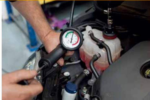
Lekt de druk weg of houdt het koelsysteem zijn druk vast?
