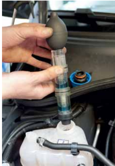
Belletjes in het overlooptankje. Zijn het luchtbelletjes van de oververhitting of is het verbrandingsgas? De vloeistof in de CO2-tester verkleurt, dus het laatste.
