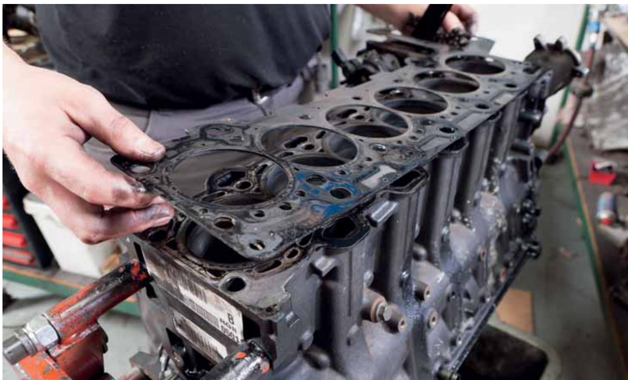
Koppakking defect? Vaak ligt de oorzaak elders. Wordt die niet weggenomen, dan leeft de opvolger niet lang.
