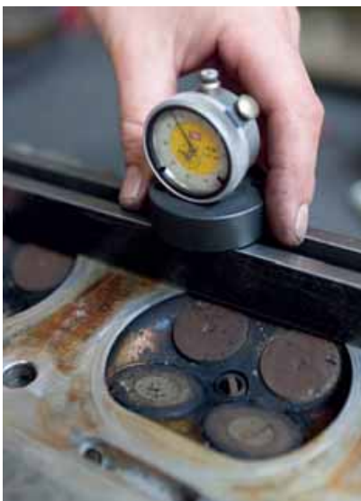
Is de cilinderkop nog vlak? Met een meetklokje op een metalen rij is de diepte te meten.
