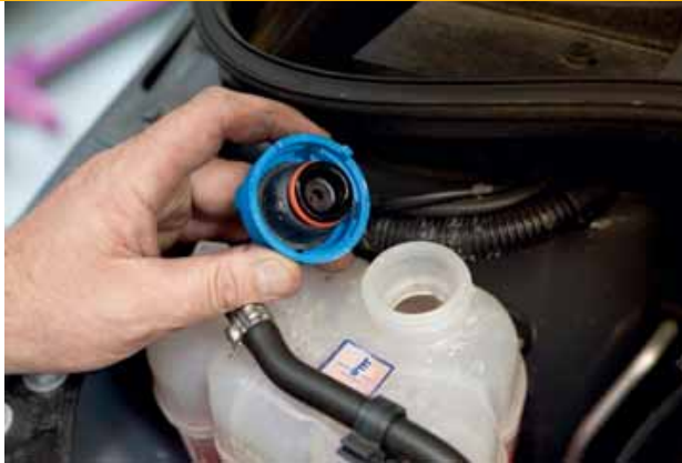
Smurrie op de dop van het overlooptankje wijst op olie in de koelvloeistof. Deze dop ziet er nog netjes uit.
