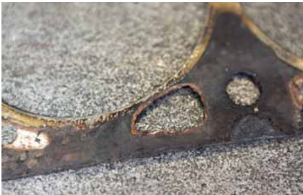
Waarom dat gat voor het koelkanaal zo groot is? Het vezelmateriaal is thermisch overbelast doordat het in aanraking is geweest met heet verbrandingsgas en daarna meegenomen door langstromende koelvloeistof.
