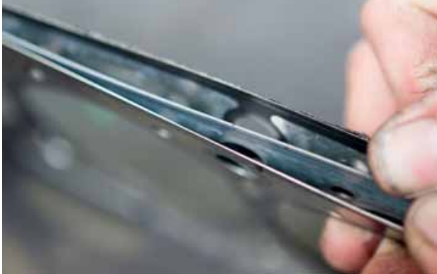
MLS-pakking ontleed: Twee metalen platen met elastomeerbedrukking erop. Daartussen een vervormbare plaat uit hoogwaardig aluminium.
