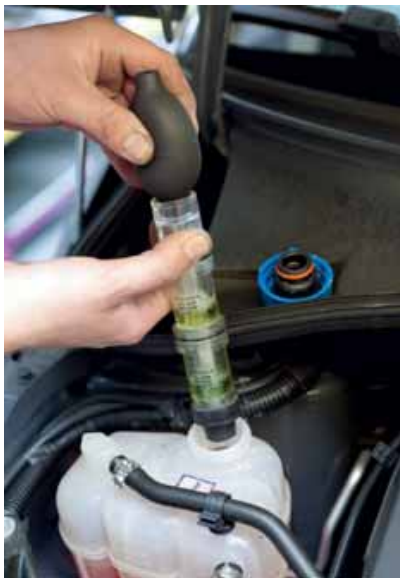
Belletjes in het overlooptankje. Zijn het luchtbelletjes van de oververhitting of is het verbrandingsgas? De vloeistof in de CO2-tester verkleurt, dus het laatste.
