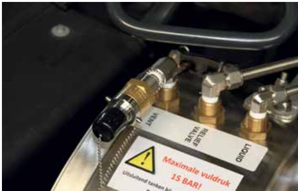
De VENT-leiding wordt gebruikt bij het tanken. Hij retourneert gas naar het vulstation en maakt zo ruimte in de tank voor vloeibaar gas.
