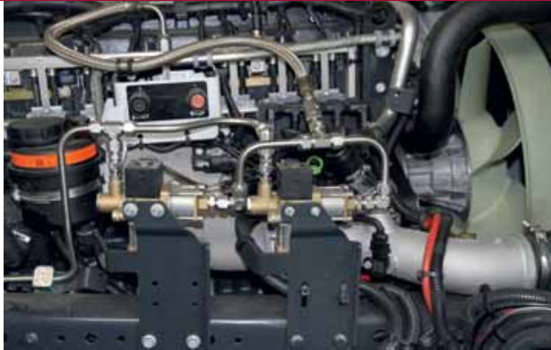
Twee reduceerventielen parallel aan elkaar zorgen voor voldoende gasdruk op het common rail-systeem.
