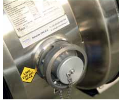
De nieuwe vulopening sluit naadloos aan op de tank.
