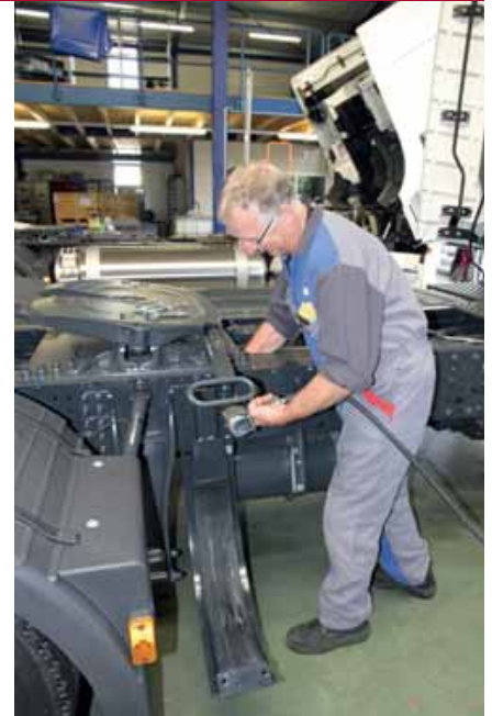
Trucktechnicus Piet van Tilburg monteert de verbeterde versie. Die omklemt de tank beter.
