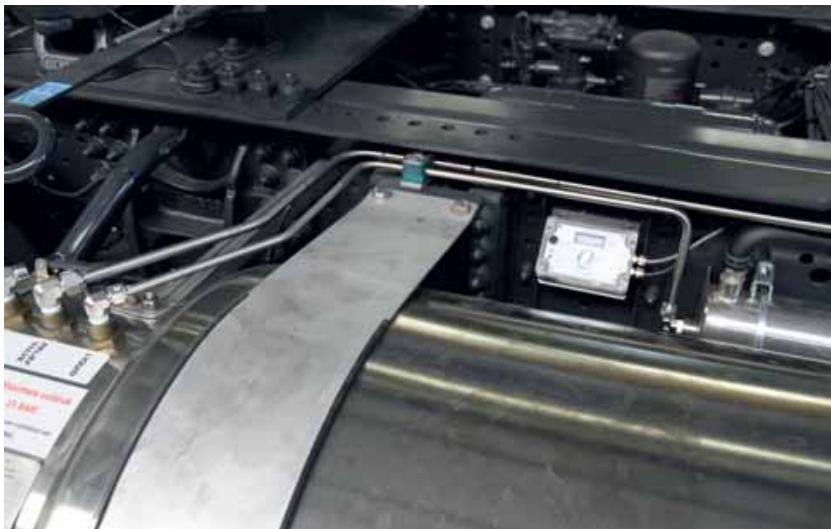
Dit is de in het begin toegepaste montagebeugel van de tank. Hij had net iets te weinig klemkracht, zodat de tank kon verdraaien.
