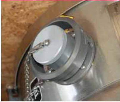
Bij de eerste serie vulopeningen kon zich vuil ophopen tussen de tank en vulhals. Inmiddels niet meer.
