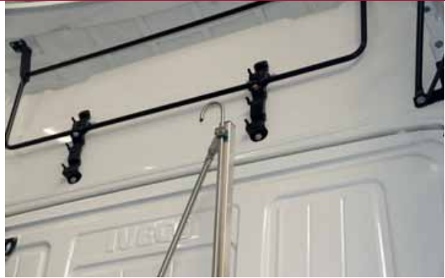
Als de truck niet rijdt warmt het ijskoude vloeibare gas op. Daarmee loopt de tankdruk op. Via deze pijp blaast de tank die overdruk af.
