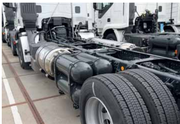
Bakwagens hebben genoeg plaats voor twee LNG-tanks. Ze wegen ieder 320 kg en ze kunnen per stuk 560 liter vloeibaar aardgas bevatten.
