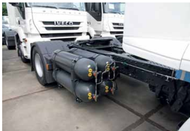
Iveco Schouten bouwt CNG-Iveco's om naar LNG. Dus moeten de vier gasflessen rechts aan het chassis plaatsmaken voor één LNG-tank.
