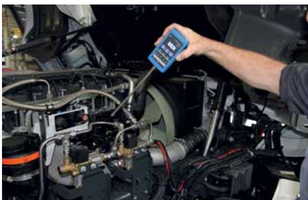
Laatste test. Alles gasdicht? Al is aardgas veiliger dan LPG, je neemt er geen risico's mee.
