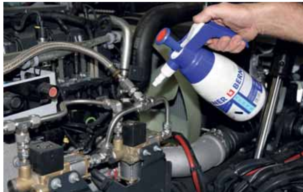
Piet van Tilburg test de gasdichtheid van het systeem met afwasmiddel.
