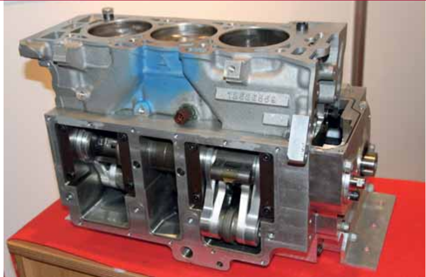
Zo ziet een Scalzo-motor er live uit. U ziet een productie-cilinderkop op een eigenbouw motorblok. De middelste cilinder is niet uitschakelbaar, daarop kan de motor starten.
