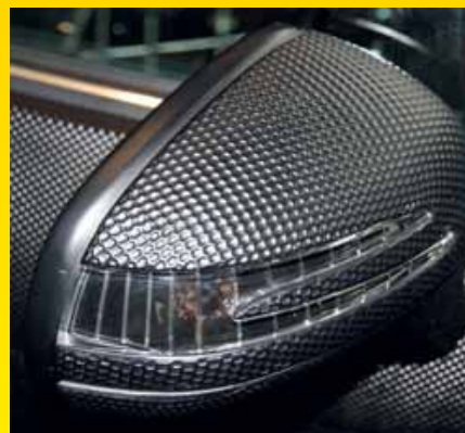
Met dit golfbaloppervlak moeten auto's boven 100 km/h zuiniger worden. Rijwind verzamelt zich in de putjes en vormt zo een soort dun luchtkussen op de auto.
