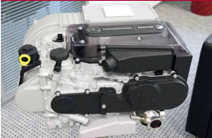
De tweecilinder is ontwikkeld voor het onderste segment. Een iets potentere versie is mogelijk om het gat met de driepitter te dichten.
