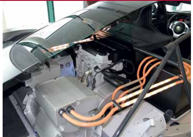
De Evija 414 Evolution heeft twee elektromotoren met elk 152 kW vermogen en 400 Nm trekkraft. Ze drijven de achterwielen aan. Elektrische actieradius: 56 km.
