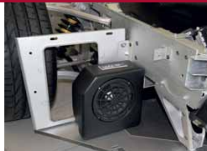
De luidspreker die fietsers en voetgangers moet waarschuwen zit achter de bumper.
